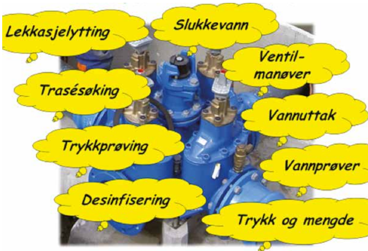
Figur 1. Vannkummens oppgaver (Illustrasjon Arve Hansen, VA-teknikk AS)
