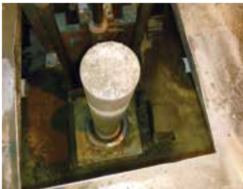
Grav med kjerne der bunnringen ligger på kjerna. Kjerna har innebygd vibrator.
