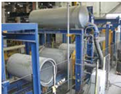
Tetthetsprøving av store rør med vann overtrykk.
