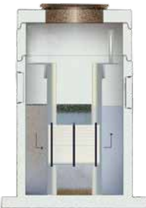
Figur 1: Viser forholdene i lamellutskilleren ved lav belastning.
