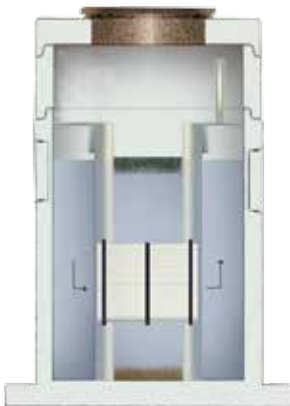
Figur 2: Viser forholdene i lamellutskilleren ved maksimal belastning.
